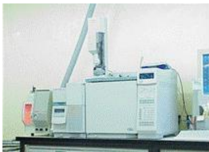
GC-MS per la determinazione di sostanze organiche volatili (sn); ICP-MS per la determinazione di metalli (dx)
