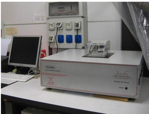
Plasma freddo Gambetti, modello Colibri per attivazioni superficiali (sn); permeabilmetro per film plastici O 2 +H 2 O Extrasolution (dx).
